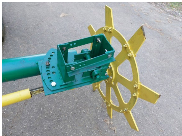
Рисунок 2. Роторный рабочий орган и узел изменения углов наклона
