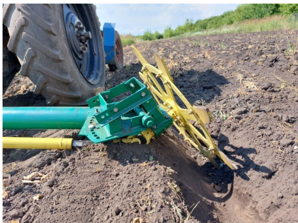
Рисунок 8. Рыхлитель с наклоном ротора в двух плоскостях
